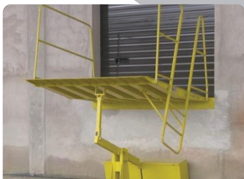
PLATAFORMA AVANÇADA CONTRA PESO
